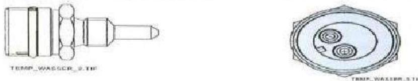
شکل (۳۰): سنسور دمای گاز ورودی به موتور و سوکت مربوطه
